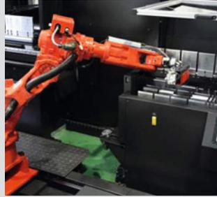
Werkzeugwechsel mit Roboter
