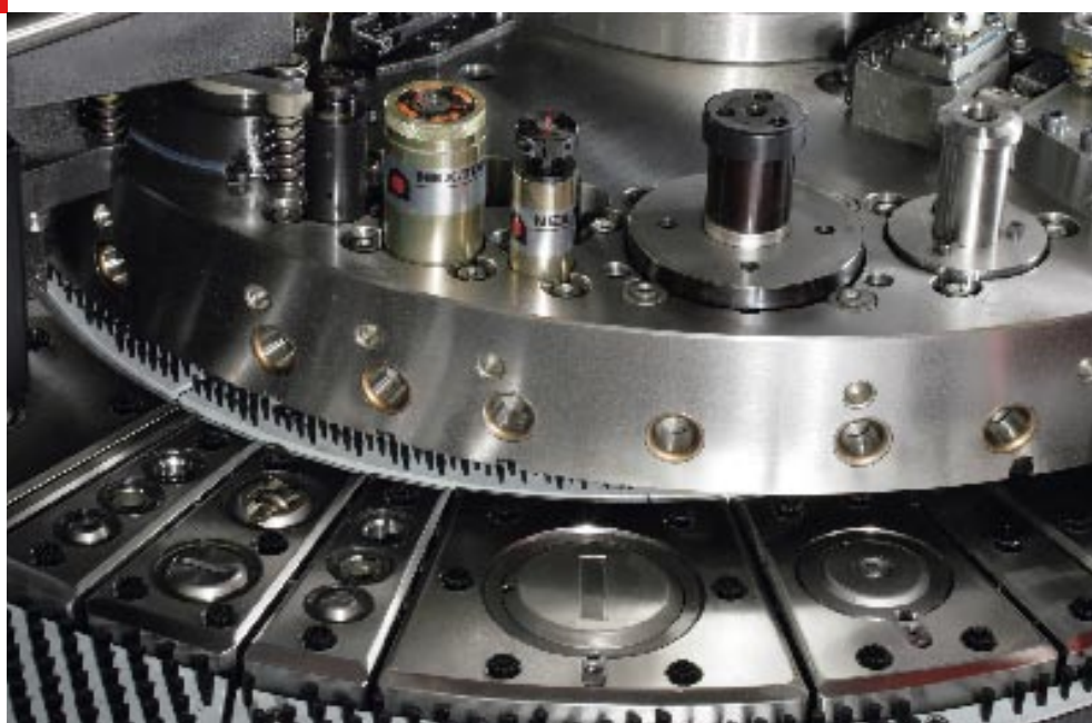
Z-револьвер на 45 инструментальных станций
