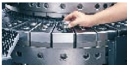
Более быстрая смена матриц в Z-револьвере с помощью встроенных выталкивателей
