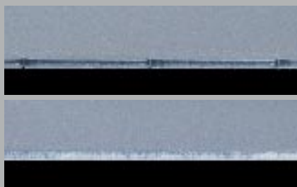
Вверху - без Slotting Tool, внизу - с Slotting Tool
