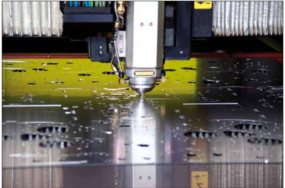
▲ Mit dem 4 kW AMADA Faserlaser lassen sich Strukturen mit hoher Schnittgüte aus 1 mm dickem Aluminiumblech schneiden.
